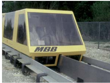
Fig. 2. Le modèle expérimental de 1972, au tout début du programme de recherche qui mènera des années plus tard au Transrapid.
