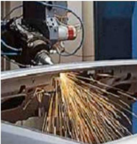
Usinage de tôle : LASER à CO<sub>2</sub> : de quelques mW à plusieurs kW, voire GW en impulsion (NIR)
